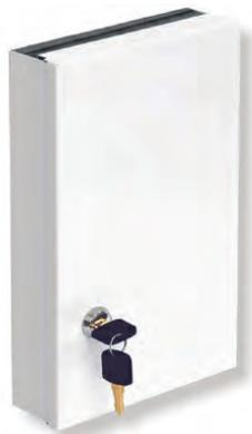
Der iv.sys SK8 Wandverteiler kann als Verteiler oder als Durchgangsspleißbox verwendet werden. Der SK8 kann mit einer Spleißkassette und einem Verteilerfeld oder mit vier Spleißkassetten bestückt werden. Ankommende und abgehende Kabel können mit Kabelbindern befestigt werden. Die Schaumstoffleisten schützen vor Staub.
