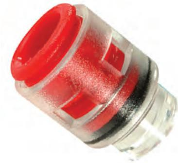
Endstopfen für Anwendungen in bestehenden Rohrtrassen. Das Produkt wird in einem transparenten Körper geliefert, um eine Belegung und die Positionierung der Mikrorohre zu überprüfen. Die Endstopfen sind bei Bedarf lösbar.
