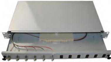
iv.sys Novuslan Spleißbox 1HE ausziehbar. Die iv.sys Novuslan Spleißbox wird nach Kundenwunsch spleißfertig bestückt. Die Box ist ausziehbar und stufenlos verstellbar. Die Pigtails sind gemäß DIN Farbcodierung in die Kupplungen gesteckt und spleißfertig in der Spleißkassette eingelegt.
