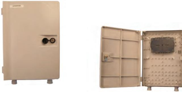
Der iv.sys Kunststoff LWL Wandverteiler ist als Spleiß- und Rangierverteiler für bis zu 24 Spleiße geeignet. Der IP54 Verteiler kann innen oder außen eingesetzt werden. Es werden 2 Spleißkassetten für bis zu 24 Spleiße mitgeliefert. Ebenso enthalten sind Adapterplatten für die Aufnahme von 12x SC simplex oder 12x LC duplex Kupplungen. Die Kabeleinführungen sind über 1 Ausbruch mit M20 (8-12mm) und 12 Ausbrüchen inkl. Dichtung für 2x1-3mm Kabel.
