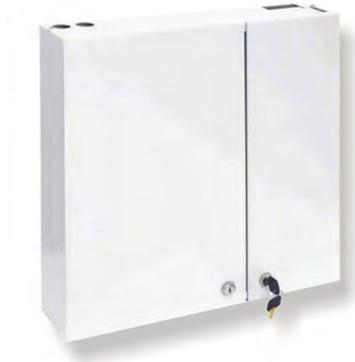
Der iv.sys SK48 Wandverteiler kann als Verteiler oder als Durchgangsspleißbox verwendet werden. Der SK48 kann mit fünf Spleißkassetten und einem Verteilerfeld oder mit zehn Spleißkassetten bestückt werden. Ankommende und abgehende Kabel können mit Kabelbindern befestigt werden. Die Schaumstoffleisten schützen vor Staub.
