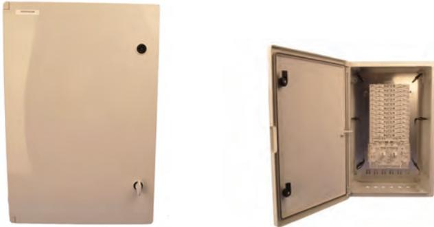
Der iv.sys Kunststoff LWL Wandverteiler ist als Spleißverteiler für bis zu 288 Spleiße geeignet. Der abschließbare IP65 Verteiler kann innen oder außen eingesetzt werden. Es werden 12 Spleißkassetten für bis zu 288 Spleiße mitgeliefert. Die Kabeleinführungen sind über 6 Ausbrüche mit M20 Verschraubungen möglich.
