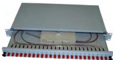
Die iv.sys Novuslan Spleißbox 1HE ausziehbar. Die iv.sys Novuslan Spleißbox wird nach Kundenwunsch spleißfertig bestückt. Die Box ist ausziehbar und stufenlos verstellbar. Die Pigtails sind gemäß DIN Farbcodierung in die Kupplungen gesteckt und spleißfertig in der Spleißkassette eingelegt.
