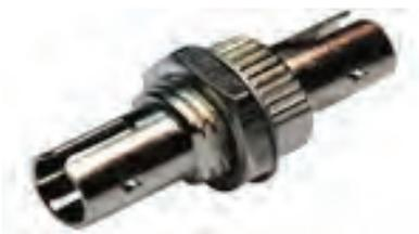
ST Kupplung im Metallgehäuse. Passen in D-hole Ausbrüche. Befestigungsmöglichkeit über eine Sechskantmutter diese ist im Lieferumfang enthalten.
