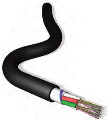
KABELSCHACHTGEEIGNETES MULTI-BÜNDELADERKABEL 12-60 FASERN Für Gebäude- und Campus-Backbone-Anwendungen, bei denen eine höhere Faseranzahl erforderlich ist. Bündeladerkabel mit einem Durchmesser von bis zu 5 x 2,5 mm, mit bis zu 12 Fasern und festem Füllmaterial. Um einen steifen, nicht-metallischen Zentrumsträger (CSM) aus Glas verseilt. Die Schicht aus wasserblockierendem Band verhindert das Eindringen von Interstitialwasser.
