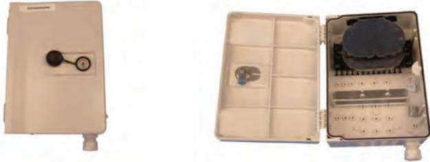
Der iv.sys Kunststoff LWL Wandverteiler ist als Spleiß- und Rangierverteiler für bis zu 24 Spleiße geeignet. Der IP54 Verteiler kann innen oder außen eingesetzt werden. Es werden 2 Spleißkassetten für bis zu 24 Spleiße mitgeliefert. Ebenso enthalten sind Adapterplatten für die Aufnahme von 12x SC duplex / 12x LC quad Kupplungen. Die Kabeleinführungen sind über 1 Ausbruch mit M20 (8-12mm) und 12 Ausbrüchen inkl. Dichtung für 2x1-3mm Kabel.
