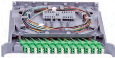
Das Novuslan Spleiß- und Patchmodul ist ein modular aufgebautes System für das Multifunktionsgehäuse MFG8 und MFG9. Das Spleiß-Patchmodul wird vorbestückt mit Kupplungen (LC/SC/E2000) und farbigen Pigtaills geliefert. Flexibles und modulares System mit hoher Faserdichte.
