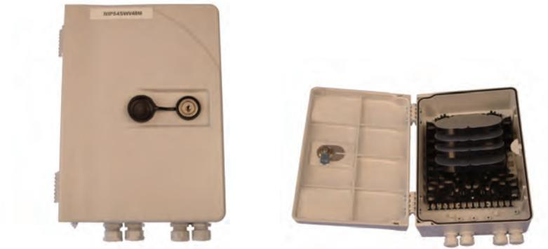
Der iv.sys Kunststoff LWL Wandverteiler ist als Spleißverteiler für bis zu 48 Spleiße geeignet. Der abschließbare IP54 Verteiler kann innen oder außen eingesetzt werden. Es werden 4 Spleißkassetten für bis zu 48 Spleiße mitgeliefert. Die Kabeleinführungen sind über 4 Ausbrüche mit M16 (5-8,5mm) Verschraubungen möglich. Inkl. Befestigungsmaterial.
