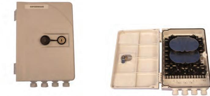
Der iv.sys Kunststoff LWL Wandverteiler ist als Spleißverteiler für bis zu 24 Spleiße geeignet. Der abschließbare IP54 Verteiler kann innen oder außen eingesetzt werden. Es werden 2 Spleißkassetten für bis zu 24 Spleiße mitgeliefert. Die Kabeleinführungen sind über 4 Ausbrüchen mit M16 (5-8,5mm) Verschraubungen möglich. Inkl. Befestigungsmaterial.
