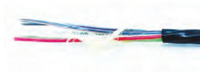
LWL Mini Kabel A-DQ2Y nx12 E9 G.657A1. Mini Kabel zum Einblasen in Mikrorohre mit 12/8mm Durchmesser.
