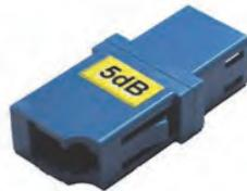
Dämpfungsglieder werden verwendet, um die Dämpfung einer Glasfaserstrecke zu erhöhen. Die Dämpfungsglieder werden benötigt, um bei kurzen Entfernungen eine Übersteuerung des Empfängers zu verhindern.
