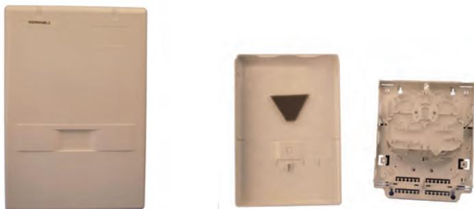
Der iv.sys Kunststoff LWL Wandverteiler ist als Spleiß- und Rangierverteiler für bis zu 48 Spleiße geeignet. Der Verteiler ist im Innenbereich einsetzbar. Es befinden sich 2 Spleißkassetten für bis zu 48 Spleiße im Verteiler. Ebenso enthalten sind Adapterplatten für die Aufnahme von 12x LC duplex oder 12x SC duplex Kupplungen. Ausbrüche für die Kabeleinführungen sind unten und oben vorhanden.
