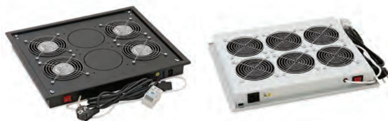
Diese Lüfterbleche wurden speziell für die Standverteiler entwickelt. Sie werden je nach Bedarf im Boden, im Dach oder der Tür der Verteiler montiert (Ausbruch 350 x 420 mm). Das Lüfterblech für Standverteiler wird im Dach von außen, im Boden von innen eingesetzt. Für eine Bodenmontage wird noch ein Montagerahmen, RAX-CH-XXX-X1, benötigt, der mit einem doppelseitigen Klebeband befestigt wird. Darüber hinaus empfehlen wir einen Sockel zum Ansaugen der Luft
