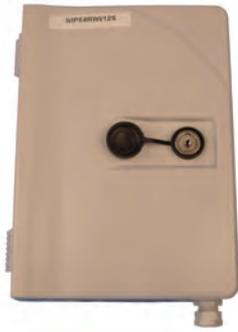
Der iv.sys Kunststoff LWL Wandverteiler ist als Spleiß- und Rangierverteiler für bis zu 24 Spleiße geeignet. Der IP54 Verteiler kann innen oder außen eingesetzt werden. Es werden 2 Spleißkassetten für bis zu 24 Spleiße mitgeliefert. Ebenso enthalten sind Adapterplatten für die Aufnahme von 12x LC duplex Kupplungen. Die Kabeleinführungen sind über 1 Ausbruch mit M12 (5-8,5mm) und 6 Ausbrüchen inkl. Dichtung für 2x1-3mm Kabel.
