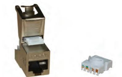
Der iv.sys Keystone Jack kann mittels watenfreien Seitenschneider in kurzer Zeit konfektioniert werden. Durch die frei zugängliche Kontaktzone ist eine perfekte Konfektionsqualität und dadurch gesicherte Übertragungsperformance gewährleistet. Das Gehäuse besteht aus vernickeltem Zinkdruckguss und erfüllt höchste mechanische- und Umwelтанforderungen. In Verbindung mit der designfähigen Modulaufnahme ist eine Kombination mit den gängigsten Schalterprogrammen möglich.
