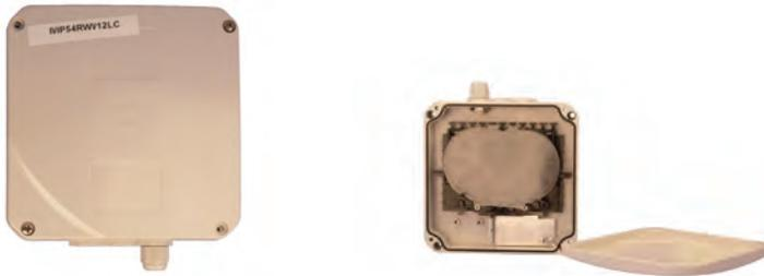
Der iv.sys Kunststoff LWL Wandverteiler ist als Spleiß- und Rangierverteiler für bis zu 12 Spleiße geeignet. Der IP54 Verteiler kann innen oder außen eingesetzt werden. Es wird eine Spleißkassette für bis zu 12 Spleiße mitgeliefert. Es können 2x LC duplex Kupplungen untergebracht werden. Die Kabeleinführung ist über eine M12 (3-6,5mm) Verschraubung und 2x 1-3mm Durchführungen möglich. Inkl. Blindstopfen und Befestigungsmaterial. Ein Schloss ist nachrüstbar.
