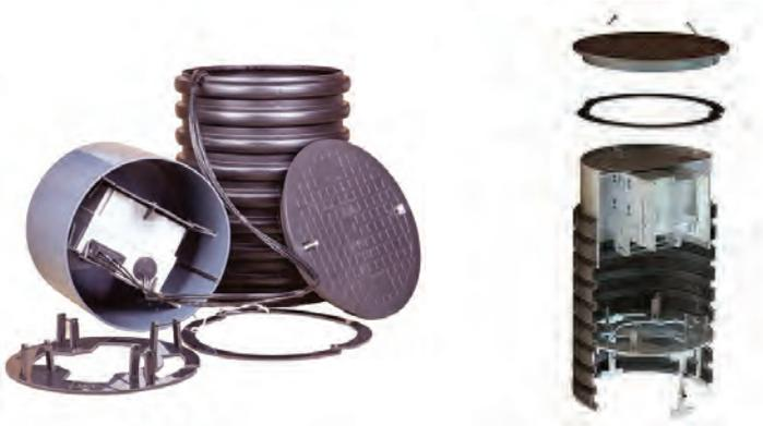
Der iv.sys Kunststoffschacht bietet eine umfassende Lösung für Glasfaserübergänge an den Verteilungspunkten in FTTx-Netzen. Die Box wird in die Tauchglocke in der Kammer gestellt, um den Zugang von Grundwasser in die Box zu verhindern. Die Kammer ist für Mikrokanalsysteme bis  $\varnothing$  16 mm ausgelegt.
