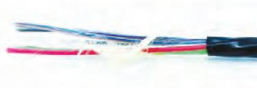
LWL Mini Kabel U-DQH nx12 E9 G.652D. Mini Kabel zum Einblasen in Mikrorohre mit 14/10mm Durchmesser.
