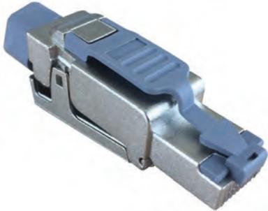
Der Feldkonfektionierbare Cat.6A Stecker kann auf Kabel von AWG 26 bis AWG 22 konfektioniert werden. Einfache Montage ohne Spezial Werkzeug.
