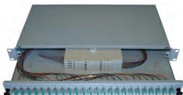
iv.sys Novuslan Spleißbox 1HE ausziehbar. Die iv.sys Novuslan Spleißbox wird nach Kundenwunsch spleißfertig bestückt. Die Box ist ausziehbar und stufenlos verstellbar. Die Pigtails sind gemäß DIN Farbcodierung in die Kupplungen gesteckt und spleißfertig in der Spleißkassette eingelegt.
