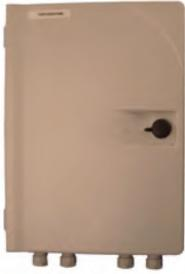
Der iv.sys Kunststoff LWL Wandverteiler ist als Spleißverteiler für bis zu 48 Spleiße geeignet. Der abschließbare IP54 Verteiler kann innen oder außen eingesetzt werden. Es werden 4 Spleißkassetten für bis zu 48 Spleiße mitgeliefert. Die Kabeleinführungen sind über 4 Ausbrüchen mit M16 (8-12mm) Verschraubungen möglich. Inkl. Befestigungsmaterial.
