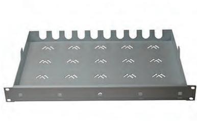
Überlängenfach zur Aufnahme von Kabelvorräten die von hinten durch geschlitzte Öffnungen eingebracht werden können. Mit Lochstrukturen im Bodenbereich für die ungehinderte Luftzirkulation.
