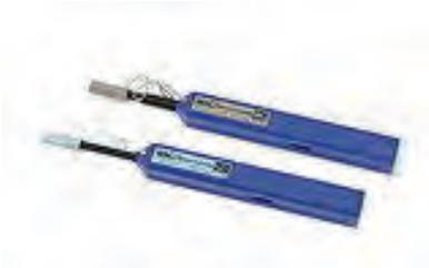
Reinigungswerkzeug zur Reinigung von Ferrulen. Reinigung der Steckerflächen im gesteckten Zustand durch die Kupplung. Ein Öffnen der Anschlussdose oder des Verteilerfeldes ist nicht nötig. Für 1,25mm oder 2,5mm Ferrulen verfügbar.
