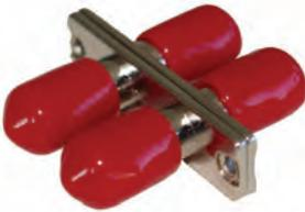
ST Duplex Kupplung im Metallgehäuse. Passen in SC-Duplex Ausbrüche. Befestigungsmöglichkeit über M2 Gewindeschrauben mit Mutter.
