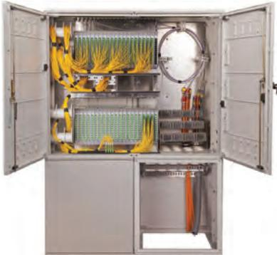
Das Multifunktionsgehäuse für außen ist dauerhaft am Boden befestigt. Schutz der montierten Ausrüstung vor Wetterbedingungen und Zugang von Unbefugten. Permanente Positionierung auf einer unterirdischen Basis, die am Boden befestigt ist. Im Dach sind Transportösen montiert. Der Verteiler bietet ein hochwertiges, integriertes, modulares optisches Management zum Terminieren oder Anschließen von optischen Kabeln in Mikrokanälen oder HDPE-Schutzrohren.
