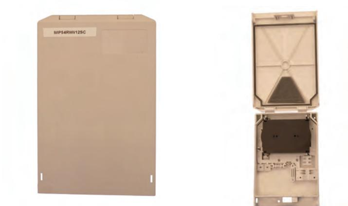
Der iv.sys Kunststoff LWL Wandverteiler ist als Spleiß- und Rangierverteiler für bis zu 12 Spleiße geeignet. Der IP54 Verteiler kann innen oder außen eingesetzt werden. Es ist das Unterbringen von 2x SC duplex oder 2x LC quad Kupplungen möglich. Ausbrüche für Kabeleinführungen 4x unten. Inkl. Blindstopfen und Befestigungsmaterial. Ein Schloss ist nachrüstbar.
