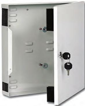
Der iv.sys SK24 Wandverteiler kann als Verteiler oder als Durchgangsspleißbox verwendet werden. Der SK24 kann mit vier Spleißkassette und einem Verteilerfeld oder mit acht Spleißkassetten bestückt werden. Ankommende und abgehende Kabel können mit Kabelbindern befestigt werden. Die Schaumstoffleisten schützen vor Staub.
