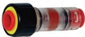
Doppelsteckmuffen für Mikrorohre mit einstellbarer gas- und wasserdichter Abdichtung. Die doppelte Abdichtung ermöglicht den gas- und wasserdichten Verschluss zwischen Kabel und Mikrorohr.
