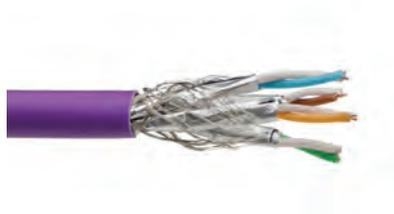
Leviton-S / FTP-Kabel der Kategorie 7 übertreffen die Leistungsstandards der Kategorie 7. Sie sind für 600 MHz und 1000 MHz spezifiziert und für die Verwendung in allen Kabelsystemen der Klasse F mit strukturierter Verkabelung geeignet. Die unterstützten Anwendungen umfassen 10 Gigabit Ethernet, Gigabit Ethernet, Power over Ethernet und Breitband-Videoübertragungen mit Frequenzen von bis zu 600 MHz.
