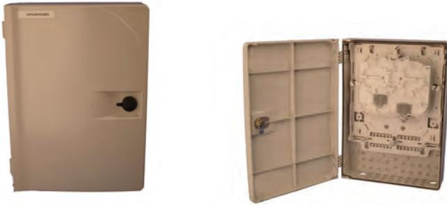
Der iv.sys Kunststoff LWL Wandverteiler ist als Spleiß- und Rangierverteiler für bis zu 48 Spleiße geeignet. Der IP54 Verteiler kann innen oder außen eingesetzt werden. Es werden 2 Spleißkassetten für 48 Spleiße mitgeliefert. Ebenso enthalten sind Adapterplatten für die Aufnahme von 12x LC duplex / 12x SC simplex oder 12x SC duplex / 12x LC quad Kupplungen. Die Kabeleinführungen sind über 2 Ausbrüche mit M20 (8-12mm) und 24 Ausbrüchen inkl. Dichtung für 2x1-3mm Kabel möglich.
