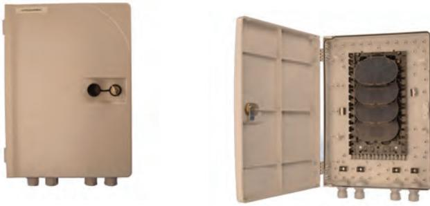
Der iv.sys Kunststoff LWL Wandverteiler ist als Spleißverteiler für bis zu 96 Spleiße geeignet. Der abschließbare IP54 Verteiler kann innen oder außen eingesetzt werden. Es werden 8 Spleißkassetten für bis zu 96 Spleiße mitgeliefert. Die Kabeleinführungen sind über 4 Ausbrüche mit M20 (8-12mm) Verschraubungen möglich. Inkl. Befestigungsmaterial.
